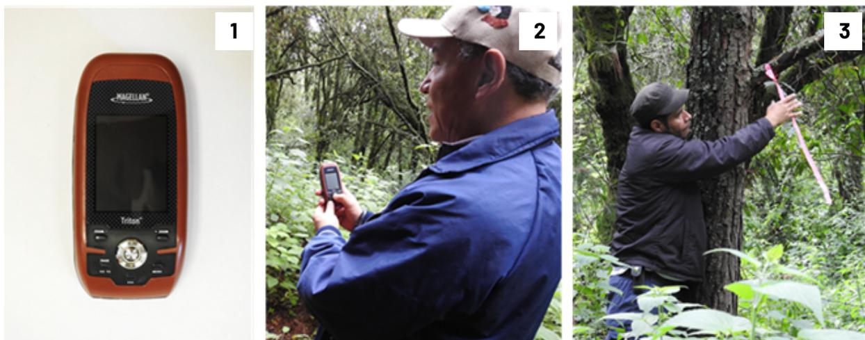
**Figura 3.** Los sitios de monitoreo se ubican mediante: 1) un geoposicionador fácil de transportar, 2) el almacenamiento de la ubicación de los sitios y el recorrido, y 3) la marcación de estos con cintas de color llamativo para facilitar su localización durante el monitoreo.
