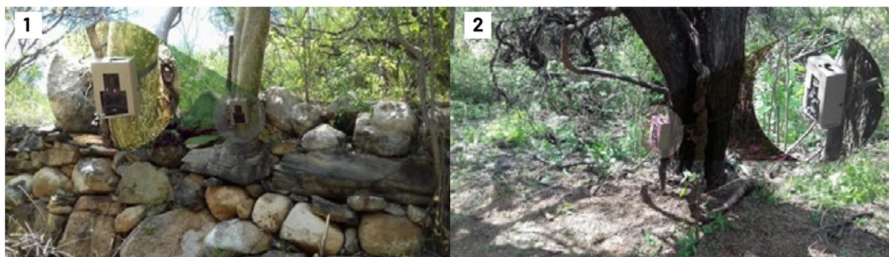
**Figura 1.** Estas CT fueron instaladas en una Unidad de Manejo de Vida Silvestre (UMAS) en Puebla, México: 1) colocación de la cámara trampa con una inclinación de 30° enfocando el sendero; 2) ubicación de la cámara trampa a 60 cm de altura, perpendicular sobre el sendero. Las cámaras están protegidas con una coraza metálica para evitar que la lluvia las dañe o que las alteren algunos animales que se acercan a morderlas.
