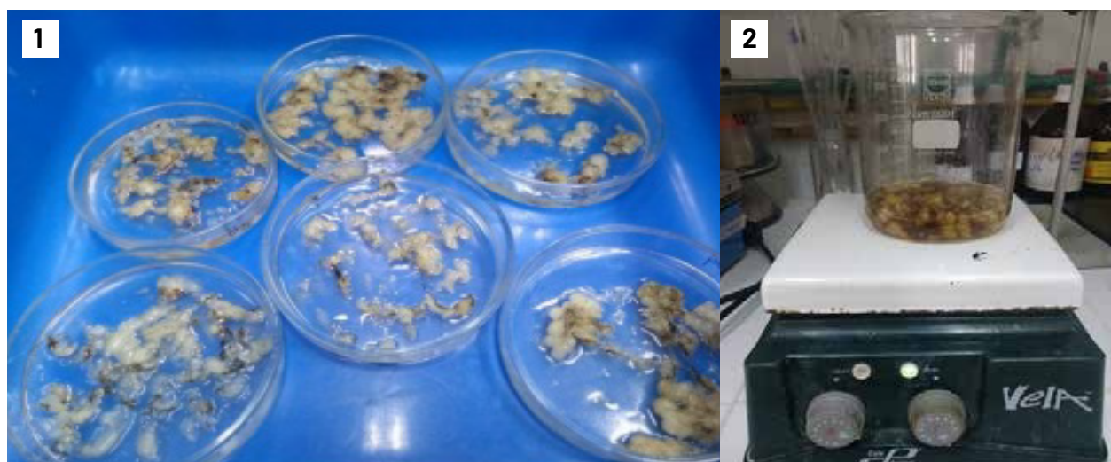
Figura 4. 1. Muestras de grasa de yacaré overo ( Caiman latirostris ) en cajas de Petri, que fueron sometidas a estufa para obtención de aceite. 2. Muestras de grasa de yacaré overo ( Caiman latirostris ) sometidas al proceso de fusión con manta de calor para obtención de aceite.
