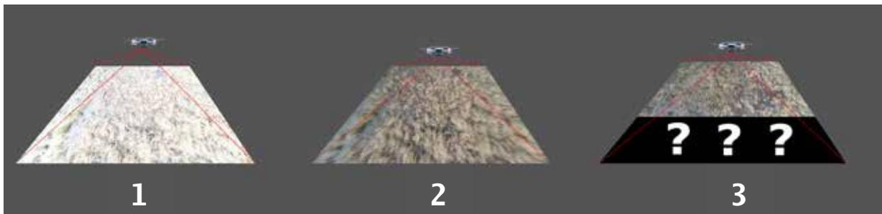
**Figura 5.** Errores en tiempo de adquisición: 1. Saturación de la imagen; 2. Corrimiento de la fotografía (imagen movida); 3. Datos incompletos.
